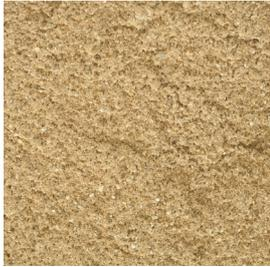
Frostsicherer, rundkörniger, kalk- und kaolinfreier Quarzsand, frei von Huminstoffen und Verunreinigungen.
