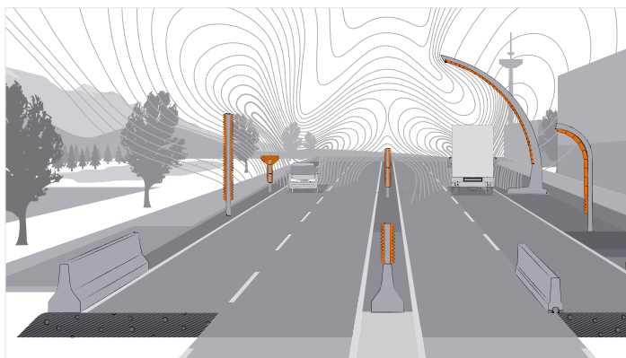
Betonleitwand, Lärmschutzwand, Lärmschutzwand mit Aufsatzelement, mobile Lärm-schutzwand (Betonleitwand mit Lärmschutzaufsatz), großer Bogen, kleiner Bogen
