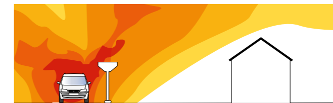
Lärmschutzwand mit Aufsatzelement
