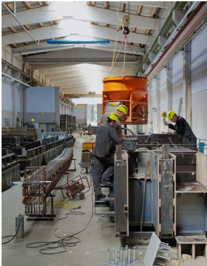
Produktion der Leube Lärmschutzwände im Werk Maishofen.
